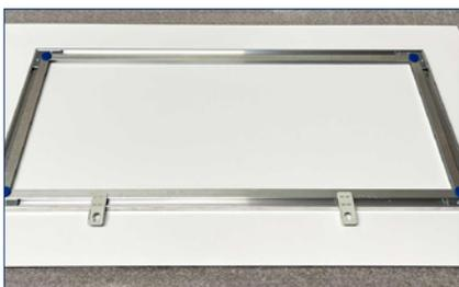
↑ Verklebtes Aluprofil auf Rückseite einer Acrylplatte
